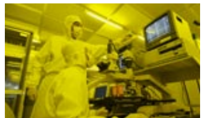
顕微鏡による、F 2 ガスを使用したドライエッチング工程を経た液晶板表面の品質検査。
